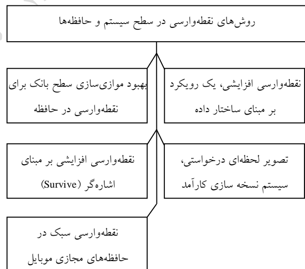
شکل (3). روش‌های کاهش سربار نقطه‌وارسی در سطح سیستم و حافظه‌ها
