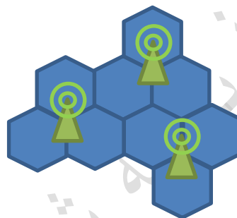
شکل ۵- نمایی از شبکه سلولی بی‌سیم با سلول‌های شش ضلعی منظم
