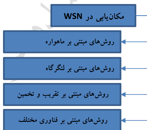
شکل ۱- دسته‌بندی روش‌های مکان‌یابی در شبکه‌های حسگر بی‌سیم
