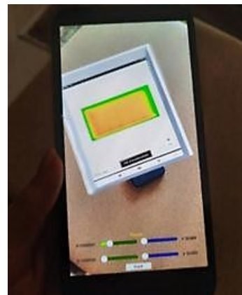
شکل (۱۵): نتایج شبیه‌سازی تغییرات دمای جسم آهنی پس از گذشت ۳۰۰ ثانیه روی صفحه X-Y و z=0.018 با استفاده از واقعیت افزوده
