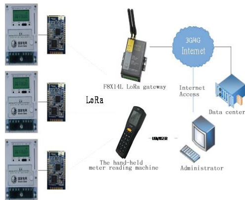
شکل (۲): کاربرد ماژول LoRa برای خواندن کنتور از فواصل دور [۲۰]
