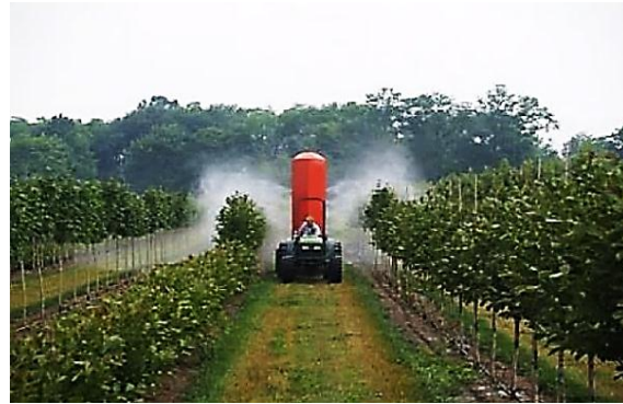
شکل (۱۰): پاشش بیش از اندازه سمپاش باغی هنگام سراسر پاشی
