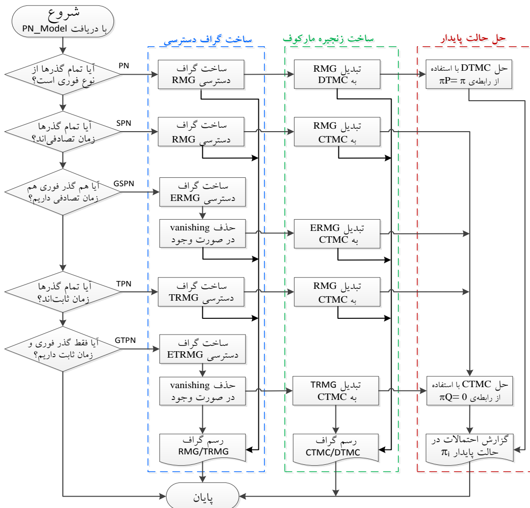
شکل (۲): نمودار گردش عملکرد KU_PN_Tool برای تحلیل حالت پایدار در پاسخ به انتخاب گزینه‌های مختلف
