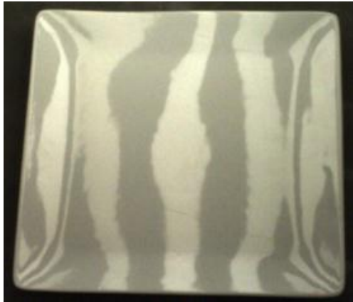
شکل (۱۳): تصویر ظرف با وجود عیب دفورمگی
