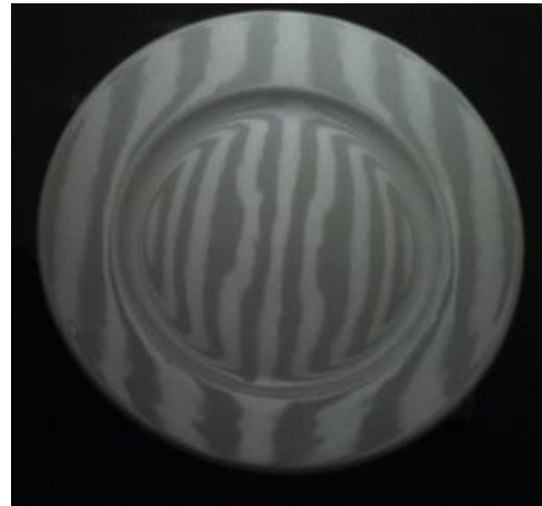
شکل (۹): تصویر ظرف بدون وجود عیب افتادگی کف
